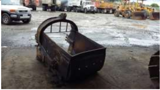
Foto 23. Reparación de cucharón
