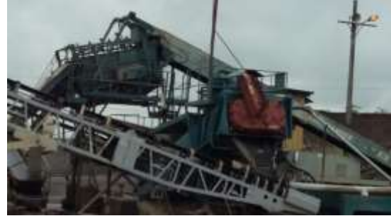
Foto 14. Otra de las clasificadoras con zaranda y banda transportadora.
