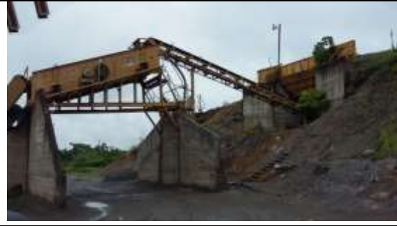
Foto 12. Tolva, banda transportadora y zaranda.
