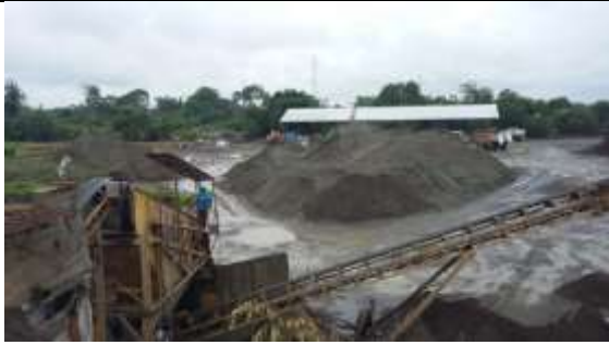
Foto 3 y 4. Cinta que transporta el material al lugar de apilamiento
