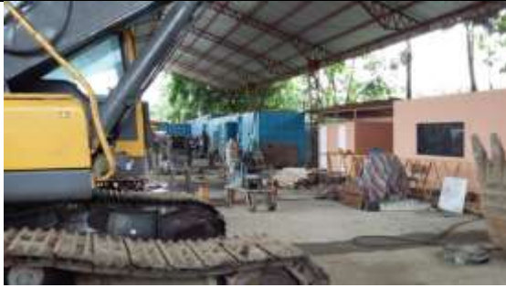
Foto 21. Cambio de zapatones del tren de rodaje.
