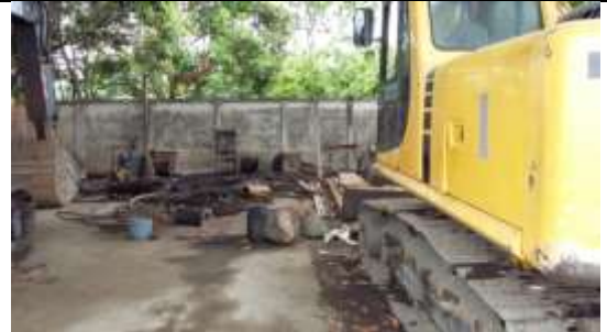
Foto 20. Reparación de tren de rodaje de excavadora
