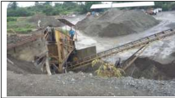
Figura 1 y 2. Tolva de alimentación donde se recibe la arena transportada por los camiones
