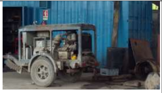
Foto 28. Equipo de soldadura portátil con motor de combustible.
